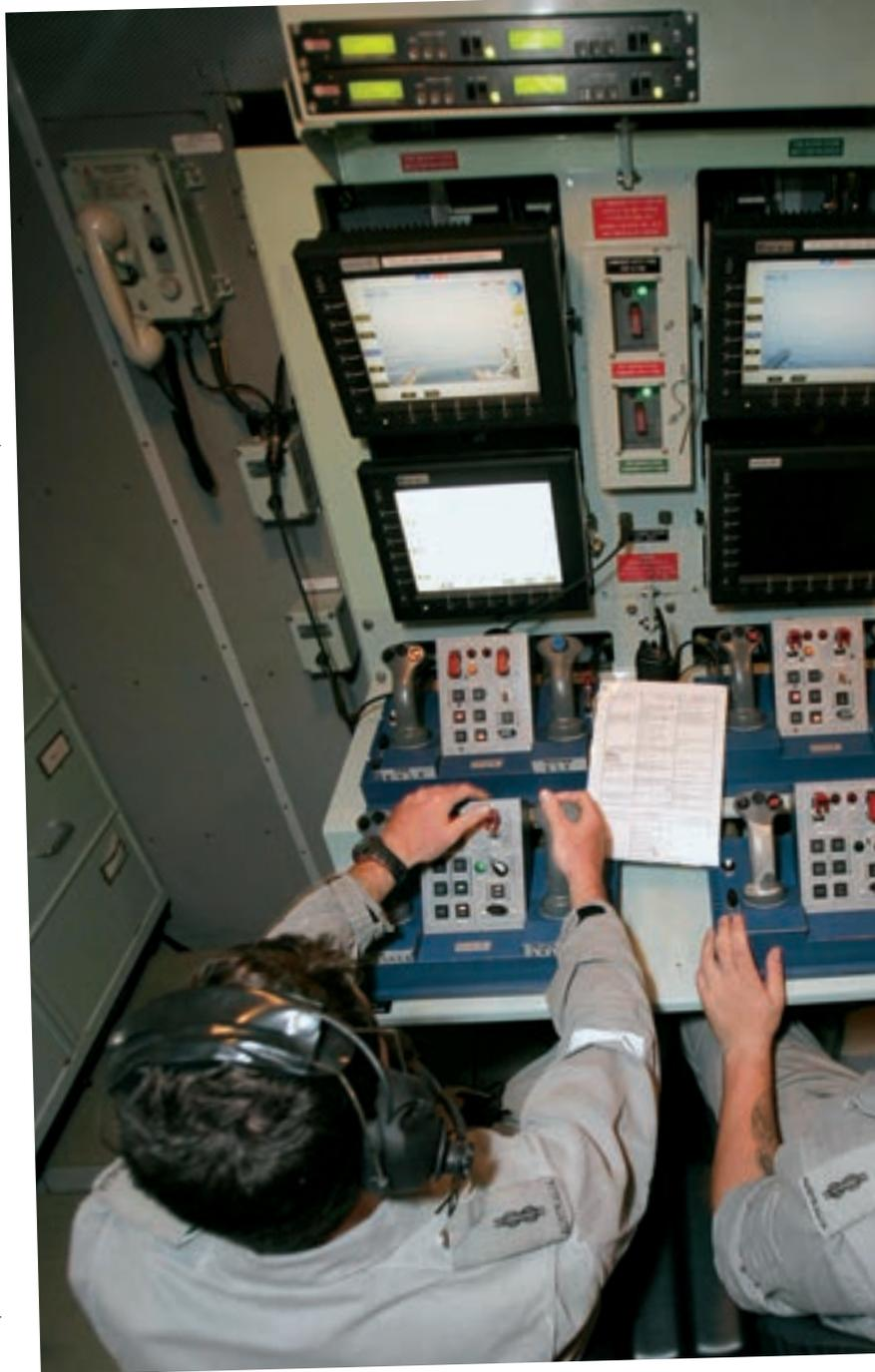
je opremljen TV kamerama i IC kamerama montiranim na oružje i na jarbolnu konstrukciju. Kamerama upravlja kontrolna konzola. Manualni (ručni) back-up modalitet dostupan je u slučaju izostanka napajanja električnom energijom, dok je servomodalitet namijenjen za servisne i neoperativne aktivnosti.
