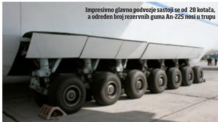
Impresivno glavno podvozje sastoji se od 28 kotača, a određen broj rezervnih guma An-225 nosi u trupu
