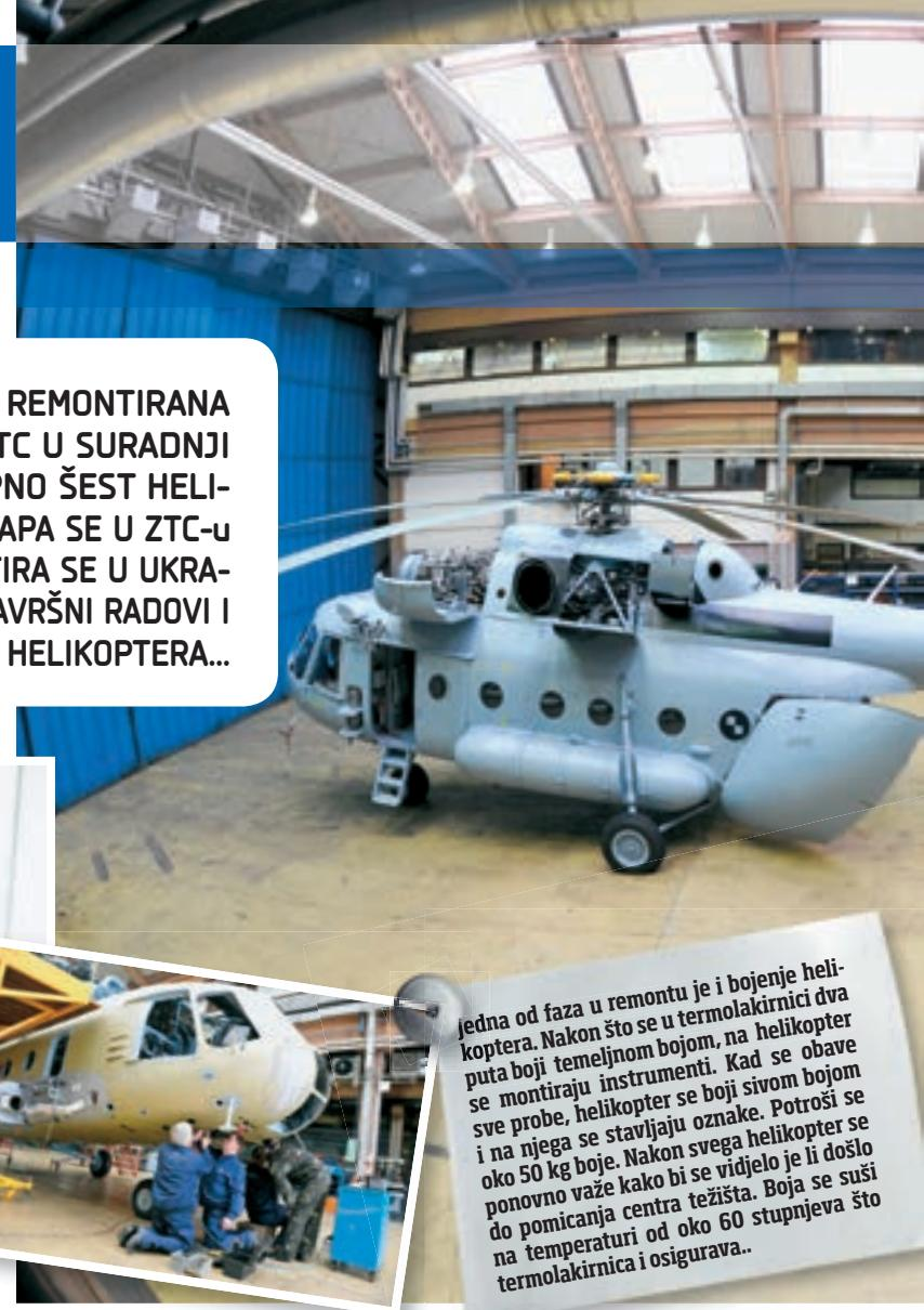
Jedna od faza u remontu je i bojenje helikoptera. Nakon što se u termolakirnici dva puta boji temeljnom bojom, na helikopter se montiraju instrumenti. Kad se obave sve probe, helikopter se boji sivom bojom i na njega se stavljaju oznake. Potroši se oko 50 kg boje. Nakon svega helikopter se ponovno važe kako bi se vidjelo je li došlo do pomicanja centra težišta. Boja se susi na temperaturi od oko 60 stupnjeva što termolakirnica i osigurava...
