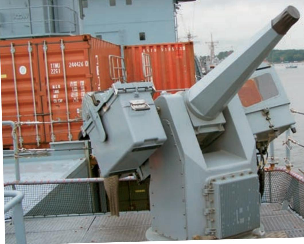
**Mornarički topnički sustav Bofors 40 mm Mk 4 ugrađen je na brod Jägaren švedske Kraljevske ratne mornarice za potrebe proizvođačkih ispitivanja. Tijekom ispitivanja topnički sustav nije bio povezan s brodskim borbenim sustavom jer ispitno plovilo rabi starci, analogni ustav no unatoč tome top je tijekom ispitivanja koristio vlastitu žirostabilizaciju**
