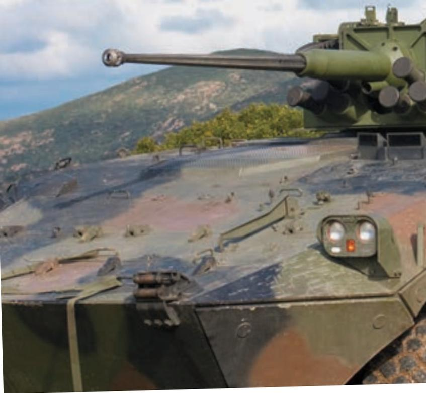
Lockheedova kupola ima top CTI 40 mm sa 70 granata i 800 metaka za spregnutu strojnicu. Masa kupole iznosi oko 3,5 tone bez oklopa, odnosno 4,5 tone s razinom 4 i dvostrukim lanserima raketa.
