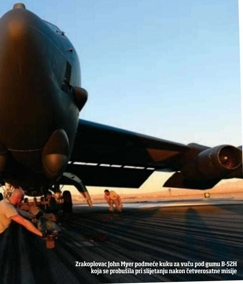
Zrakoplovac John Myer podmeće kuku za vuču pod gumu B-52H koja se probušila pri slijetanju nakon četverosatne misije
