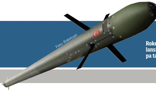
Roketsanov laserski navođen CIRIT može se lansirati s raznih oružnih sustava i platformi, pa tako i površinskih plovnih jedinica
