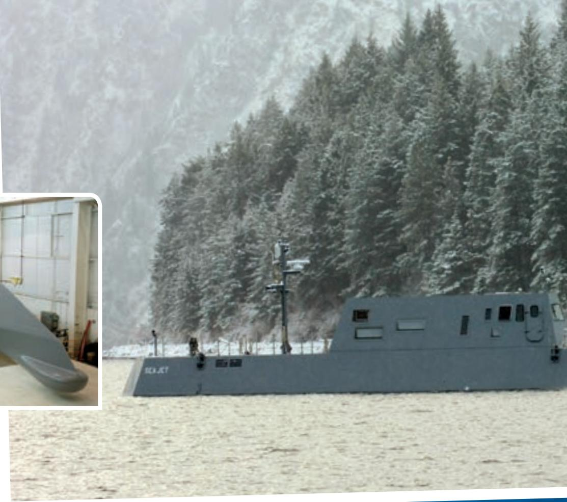
Fotografija s testiranja Sea Jeta, 40-metarskog demonstratora naprednog električnog broda (AESD) na jezeru Pend Oreille, Idaho, snimljena je u studenom 2005. Istraživanja je provodio američki ured za pomorska istraživanja. Lijevo gore je Sea Jet na suhom. Zanimljiv je tumblehome dizajn trupa plovila koji je poslije primijenjen na novoj klasi razarača
