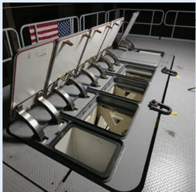
VLS komponenta izvornog naziva *Peripheral Vertical Launch System* (PVLS), tj. periferni vertikalni lansirni sustav, sa službenom mornaričkom nomenklaturom Mk-57
