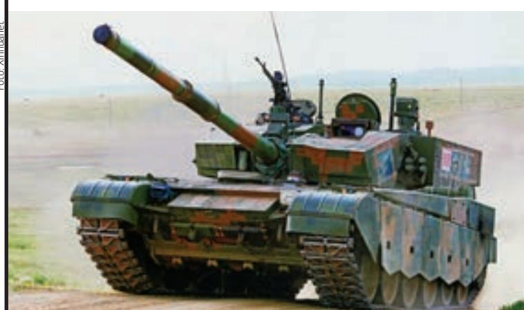
**Društvo osnovnom naoružanju, topu i protuoklopu, daje sekundarno naoružanje: spregnuta strojnica Type-86 7,62 mm i protuzrakoplovna strojnica Type-88 12,7 mm**
