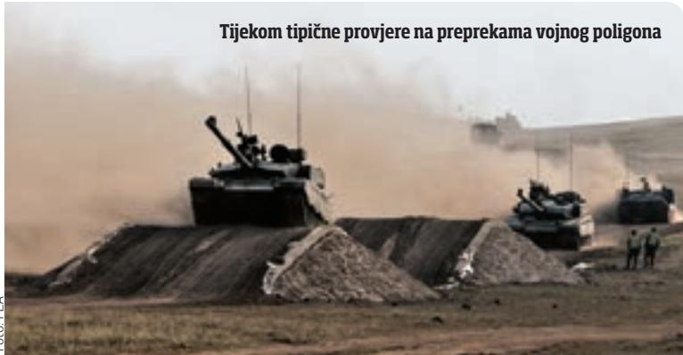
slične na one tenka Leopard) mogu se kompletirati s gumenim dodacima za zaštitu asfaltnih puteva. Eksploatacijski vijek gusjenica je oko 10 000 km. Zbog veće dužine tenka, masa jedne gusjenice je oko 2100 kg (kod T-72 1723 kg). Hodni dio ima šest pari potpornih kotača, ali s povećanim razmakom zbog produženog tijela tenka, i po četiri para kotača nosača gusjenica.
