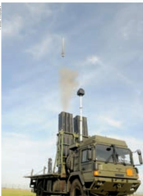
**Pogled s prednje strane MAN-a na lansiranje projektila CAMM-L. Raketa vuče korijen iz zrak-zrak rakete kratkog dometa AIM-132 ASRAAM**
