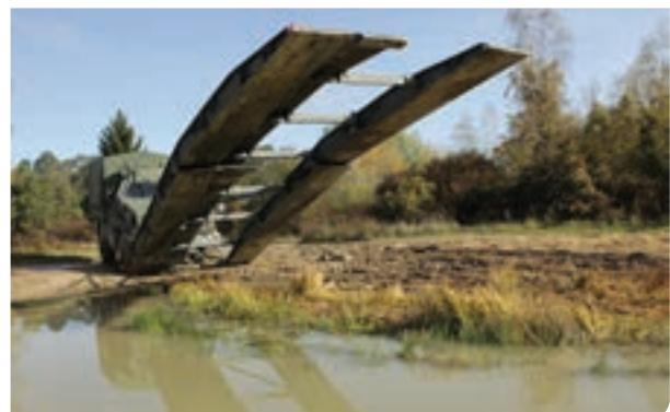
Krajem 2013. njemački je KMW predstavio sustav za podršku lakinim vozilima na kotačima Heavy Short Trackway Bridging (HSTB), koji premošćuje razmake od četiri ili osam metara, a nosivost mu je u klasi MLC 40
