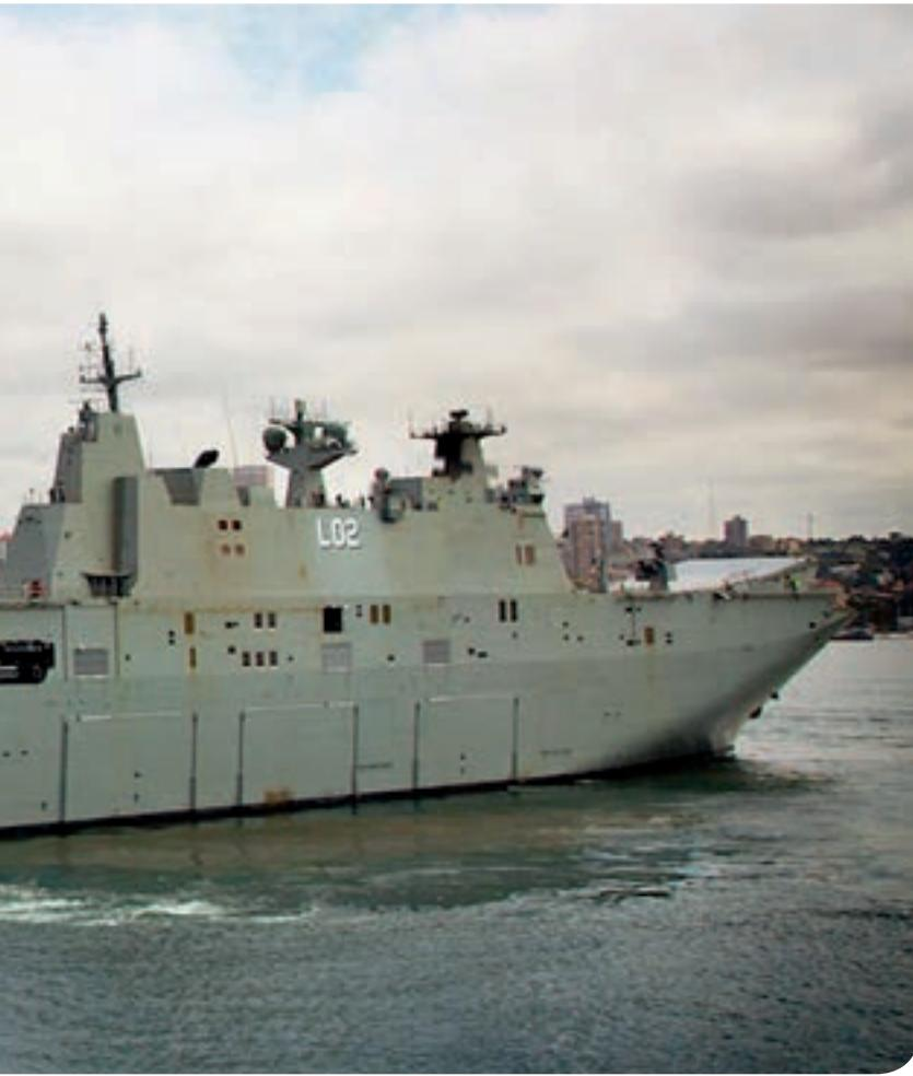
ge 17,4 MW i dvaju dizelskih motora, pojedinačne snage 7,2 MW, čime se postiže najveća brzina iznad 20 čvorova. Doplov pri konstantnoj brzini od 15 čvorova iznosi 9000 NM. Temeljno se naoružanje sastoji od šest strojnica kalibra 12,7 mm te četiriju Rafaelović
