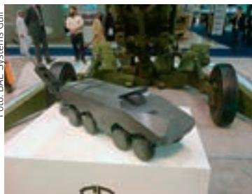
**Na osnovi M777 BAE namjerava razviti i druge sustave. Najnoviji je prikazan maketom na sajmu IDEX u UAE-u u veljači ove godine. Riječ je o spoju haubice s emiratskim oklopnim vozilom Enigma. Bilo bi to prvo postavljanje takve haubice na vozilo s kotačima 8 x 8**
