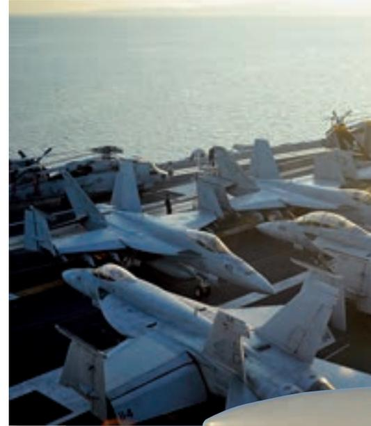
40 sekundi danju ili 60 sekundi noću mogu lansirati katapultom dva aviona. Tako lansirani avioni u dvije sekunde dostižu brzinu od 0 do 265 km/s. Pri slijetanju avioni se kukom zakvače za jedno od četiri čelična užeta koji osiguravaju zaustavljanje na prostoru ne dužem od 100 metara.
