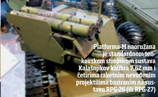
Platforma-M naoružana je standardnom tenkovskom strojnicom sustava Kalašnjikov kalibra 7,62 mm i četirima raketnim nevodjenim projektilima baziranim na sustavu RPG-26 (ili RPG-27)
