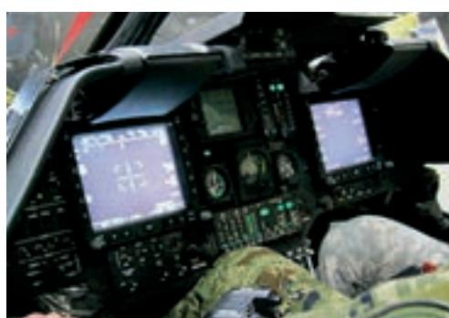
Kiowa Warrior umjesto klasičnih analognih pokazivača ima Digital Cockpit (Glass Cockpit and Display control system) pa se može reći da zahtijeva visoke sposobnosti i operatera i pilota
