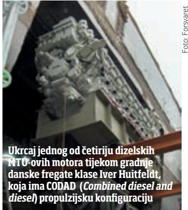
**Ukrcaj jednog od četiriju dizelskih MTU-ovih motora tijekom gradnje danske fregate klase Iver Huitfeldt, koja ima CODAD (Combined diesel and diesel) propulzijsku konfiguraciju**
