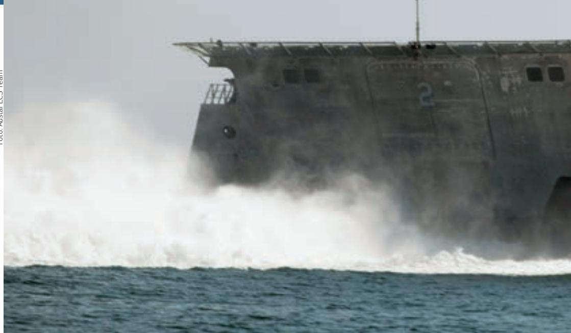
Obje inačice američkih LCS-a koriste vodomlazne propulzore (WJ - waterjetove) adaptirane u CODAG-WJ konfiguraciju
