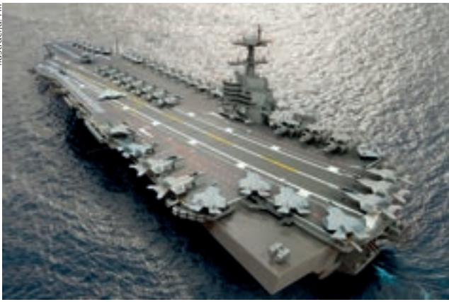
CIWS top Vulcan Phalanx instaliran po sredini krmenog zrcala, a ostala dva po sredini broda na sličnim sponsonima kao i raketni PZO sustavi. Takvim se rasporedom CIWS oružnih sustava nastojalo stvoriti obrambeni pokrivač učinkovit protiv svih simetričnih i asimetričnih prijetnji koji bi trebalo biti nadopunjeno i djelovanjem teških strojnica kalibra 12,7 mm.
