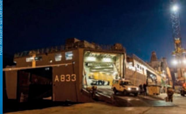
Radi iskrcajno/prekrcajnih operacija na moru JSS je opremljen s dva LCVP plovila (*Landing craft vehicle/personal*) koja su ugurana u niše na krmi i smještena na posebnim sohama. Za transfer desantnih plovila s broda i na brod služi zaštićena krmena rampa.
