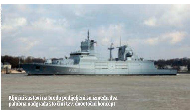
**Ključni sustavi na brodu podijeljeni su između dva palubna nadgrada što čini tzv. dvootočni koncept**
