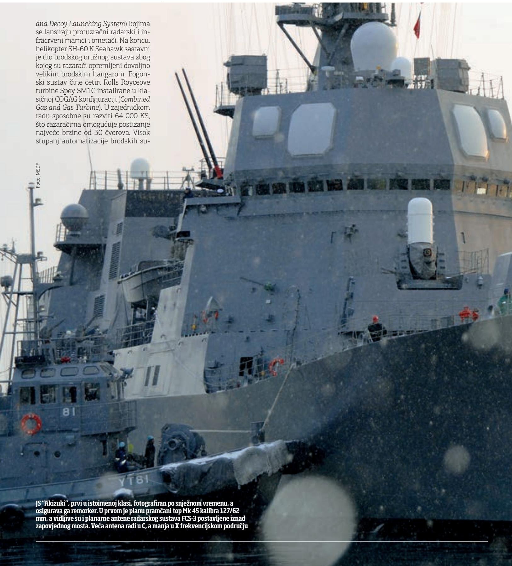
JS "Akizuki", prvi u istoimenoj klasi, fotografiran po snježnom vremenu, a osigurava ga remorker. U prvom je planu pramčani top Mk 45 kalibra 127/62 mm, a vidljive su i planarne antene radarskog sustava FCS-3 postavljene iznad zapovjednog mosta. Veća antena radi u C, a manja u X frekvencijskom području
