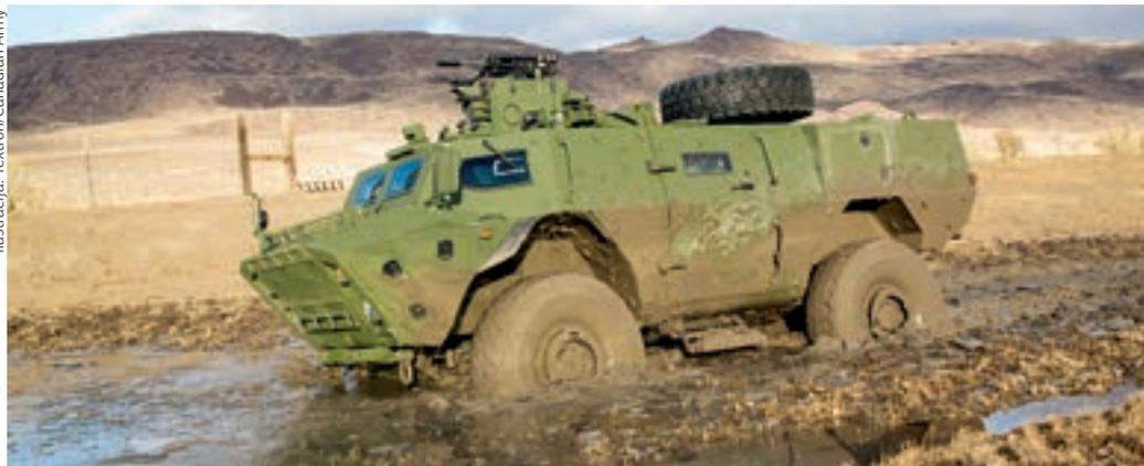
Motor Cummins QSL 365 snage 365 KS uparen je s automatskom transmisijom Allison 3200 SP čime vozilo postiže najveću brzinu od 105 km/h
