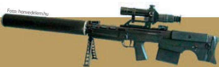
*bull-pup* izvedbi, ukupne duljine oko 1420 mm, uz duljinu cijevi 1000 mm, a masa je 12 kg bez optičkog ciljnika. Na cijevi se nalazi kombinacija plinske kočnice i prigušivača zvuka. Puni se spremnikom kapaciteta pet metaka kao i OSV-96, ali nije poluautomatska nego repetirka. Opremljena je standardnom ruskom šinom za montažu optike (žlijebnom). Učinkoviti domet je 1500 m, a krajnji 2000 m.
