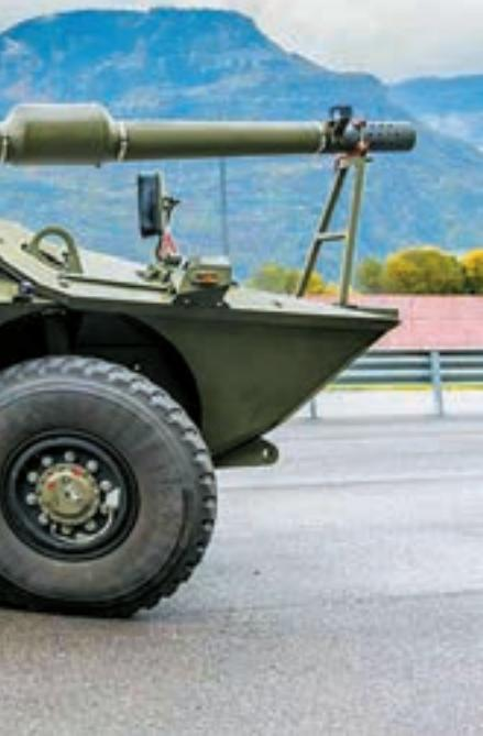
**Top 120/45 mm** nastao je na osnovi topa 120/44 na tenku Ariete. U izradi je korištena nova vrsta čelika koja je omogućila povećanje tlaka u cijevi
