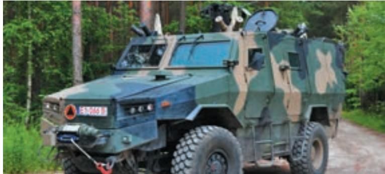
**Topničko izvidničko vozilo dizajnirano je za optoelektroničko izviđanje s tla i potporu paljbenih zadaća samohodnim haubicama 155 mm i minobacačima 120 mm**
