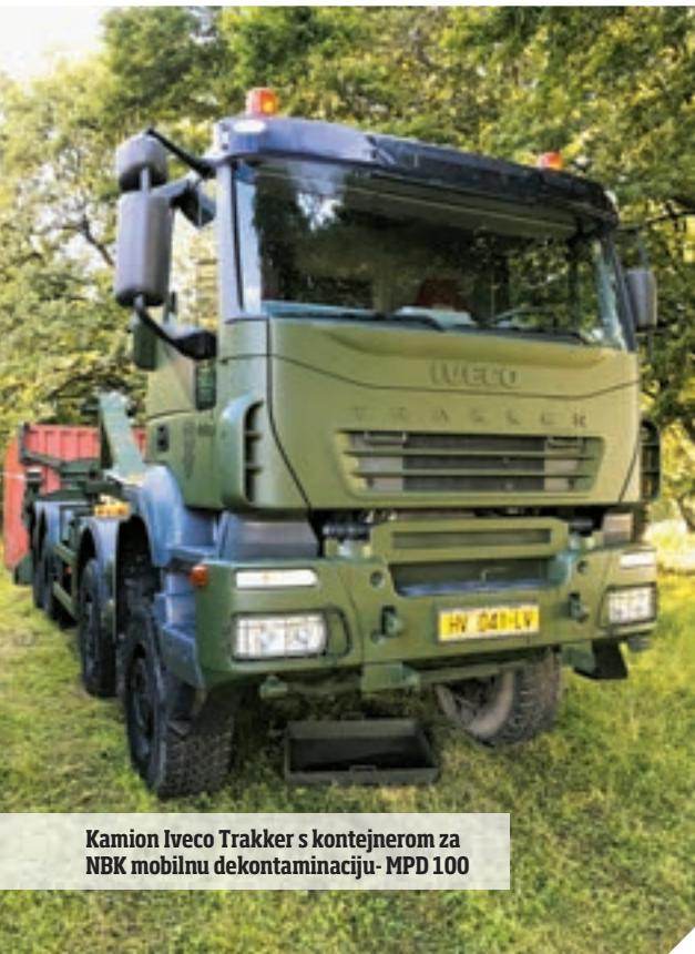
Kamion Iveco Trakker s kontejnerom za NBK mobilnu dekontaminaciju - MPD 100
