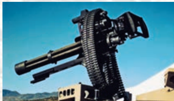
GAU-19/B kalibra 12,7 mm ima neusporediv broj od 40 000 ispaljenih metaka između dvaju zastoja
