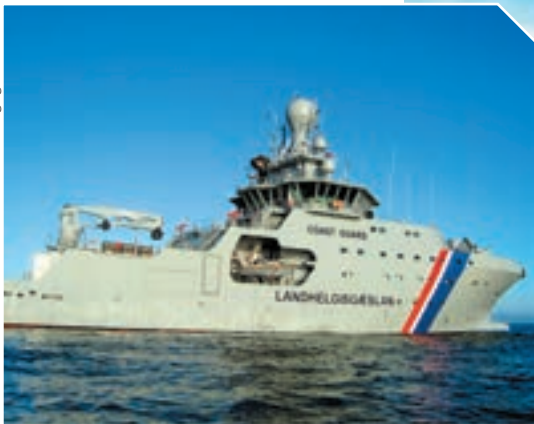
Višenamjenski brod "Thor", građen u Čileu prema dizajnu Rolls-Royceova UT 512 L, u operativnoj je uporabi od 2011. godine
