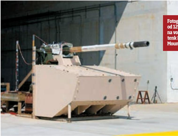
Fotografija s testiranja topa XM-360 od 120 mm koji je trebao biti instaliran na vozilo koje bi čak moglo zamijeniti tenk M1 Abrams, tj. oklopnjak XM-1202 Mounted Combat System
