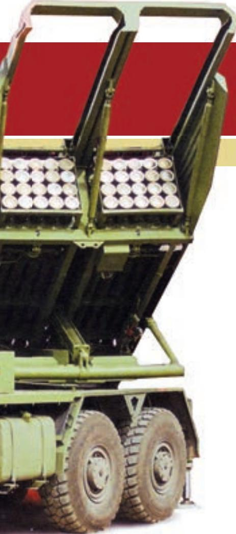
Važno je napomenuti da su rakete tvornički ugrađene i zatvorene unutar kontejnera. Standardni kontejner 220 mm sadrži šest raketa dometa do 70 km, a kontejner 122 mm ukupno 20 raketa dometa do 50 km. Žanimljivo je da SR5 može nositi kombinaciju s različitim raketnim kontejnerima, jednim s raketama 220 mm, a drugim od 122 mm. Vjerojatno bi mogle biti uvedene i rakete drugih kalibara.
