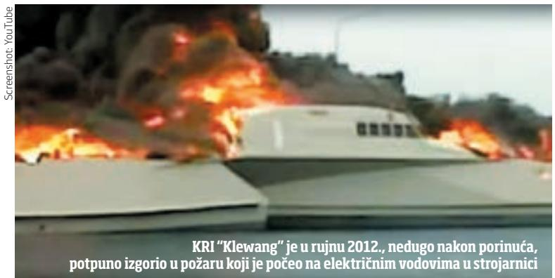
**KRI "Klewang" je u rujnu 2012., nedugo nakon porinuća, potpuno izgorio u požaru koji je počeo na električnim vodovima u strojarnici**
