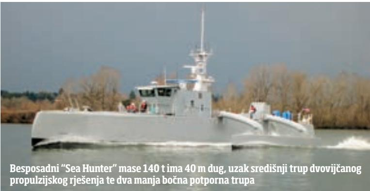
**Besposadni "Sea Hunter" mase 140 t ima 40 m dug, uzak središnji trup dvovijčanog propulzijskog rješenja te dva manja bočna potorna trupa**
