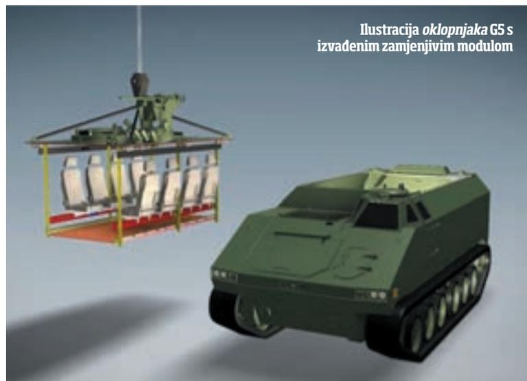
Ilustracija oklopnjaka G5 s izvedenim zamjenjivim modulom
