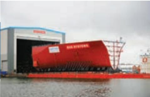
**Transport jednog od blokova od kojih je konstruiran nosač zrakoplova HMS "Queen Elizabeth". Takav način brodogradnje namjerava se primjeniti i na fregatama Type 31e**
