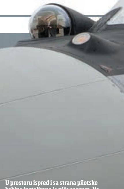
**U prostoru ispred i sa strana pilotske kabine instalirano je više senzora. Na slici se može vidjeti elektrooptički sustav OLS-35, senzori za otkrivanje napadačkih raket i detektor laserskog zračenja. U sklopljenom položaju vidljiv je i priključak za dopunjavanje goriva u zraku**
