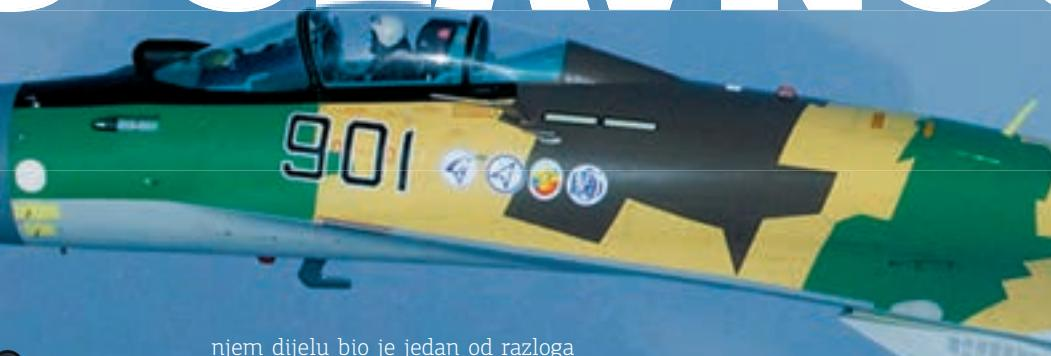
**Prvi prototip Su-35 (901). Na vrhu nosa još se može vidjeti Pitotova cijev, koja će na novijim serijskim zrakoplovima biti uklonjena**
