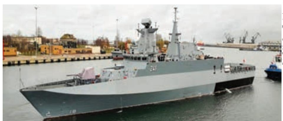
MEKO A-100 razvijenom u njemačkom brodogradilištu Blohm+Voss grupacije ThyssenKrupp Marine Systems, a istiskuje 1800 tona. Temeljno naoružanje čini OTO Melarin pramčani top kalibra 76 mm, dva topa kalibra 30 mm MARLIN-WS i četiri Grom prijenosna lansera PZO raketa kratkog dometa. U skladu s projektnim rješenjem, predviđena je krmena letna paluba
