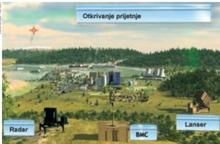
Rafaelova ilustracija prikazuje glavne komponente sustava Iron Dome: radar, lanser te kontrolnu i zapovjednu jedinicu BMC (Battle Management Control)
