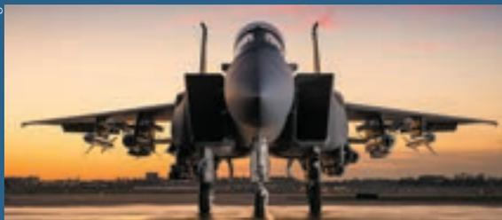
**Novi Eagle s potpunim FBW sustavom upravljanja i aktiviranim vanjskim nosačima s proturadarskim raketama HARM. Među oružjem su GPS vođene bombe GBU-38, bombe manjeg promjera SDB, krstareće rakete SLAM, rakete zrak-zrak AMRAAM i Sidewinder**
