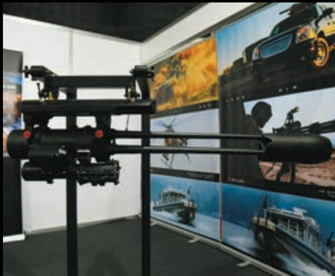
Dillon 503D, prototip strojnica sustava Gatling u kalibru .50 (12,7 x 99 mm)
