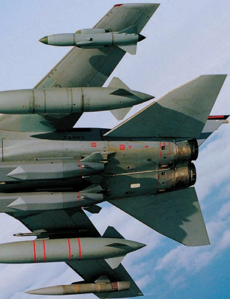
Tornado GR4 s dvjema krstarećim raketama Storm Shadow na podtrupnim nosačima. Tijekom 2003. ubrzano su stavljene u uporabu kako bi bile spremne za operaciju Telic u Iraku
