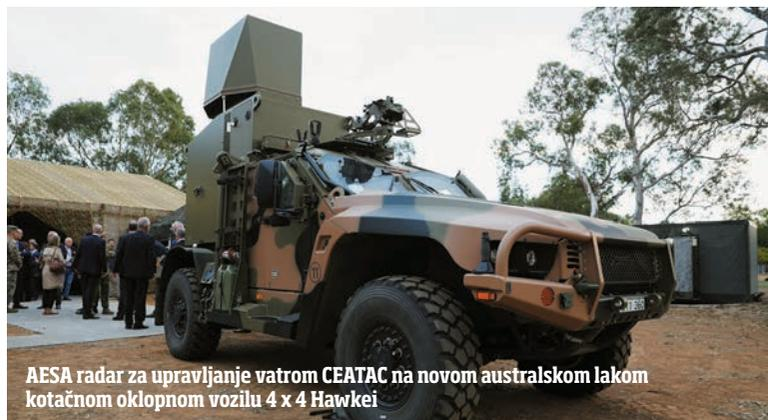
**AESA radar za upravljanje vatrom CEATAC na novom australskom lakom kotačnom oklopnom vozilu 4 x 4 Hawkei**
