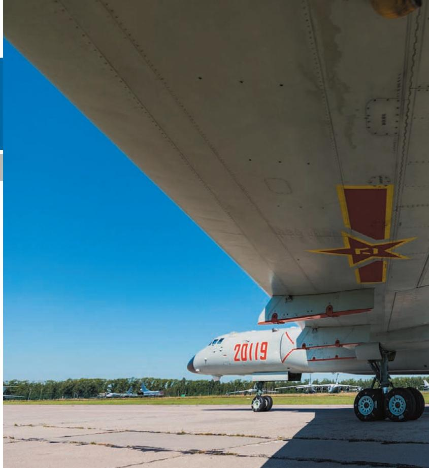
**Xi'an H-6K najnovija je inačica bombardera temeljenog na dizajnu sovjetskog Tu-16. Zamišljen je u prvom redu kao platforma za lansiranje krstarećih raketa zrak-zemlja i zrak-površina velikog dometa**
