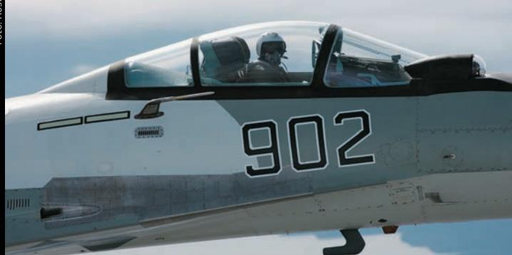
**IRST elektrooptički motrični sustav na Su-35 smješten je neposredno ispred pilotske kabine**
