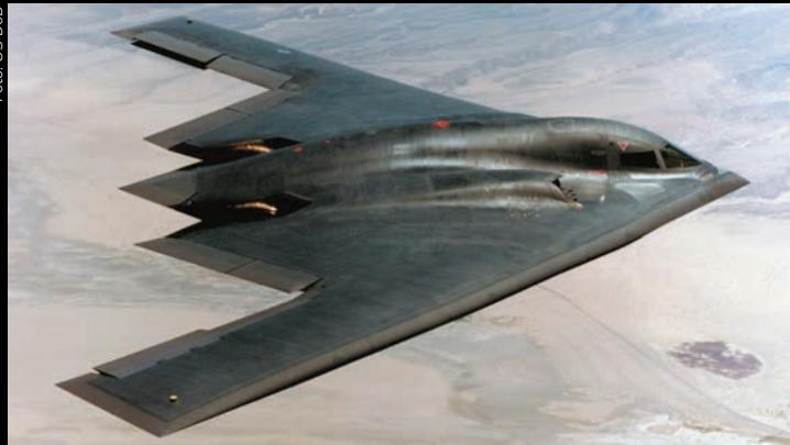
**YF-23 (sasvim gore) imao je sustav za hlađenje ispušnih plinova turboventilatorskih motora kako bi mu se smanjio termički potpis. Slično je rješenje i na bombarderu B-2 (gore)**
