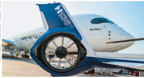
**Repni rotor tipa fenestron na helikopteru Airbus H135. Uz smanjenje buke, prednost je fenestrona i povećana otpornost na oštećenja**
