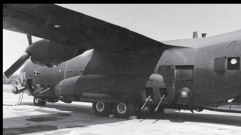
visine zrakoplova kako bi vršilo ko-rekcije za bojni ciljnik zapovjednika zrakoplova. Ostali su sustavi uključivali: FLIR, sustav za noćno motrenje, navigacijski Dopplerov radar, bočno pretražujući radar, poluautomatski izbacivač baklji i reflektor za osvjetljavanje ciljeva snage 20 kW, koji je mogao djelovati u vidljivom i infracrvenom dijelu spektra. Avion je tijekom ljeta 1967. prebačen u bazu
