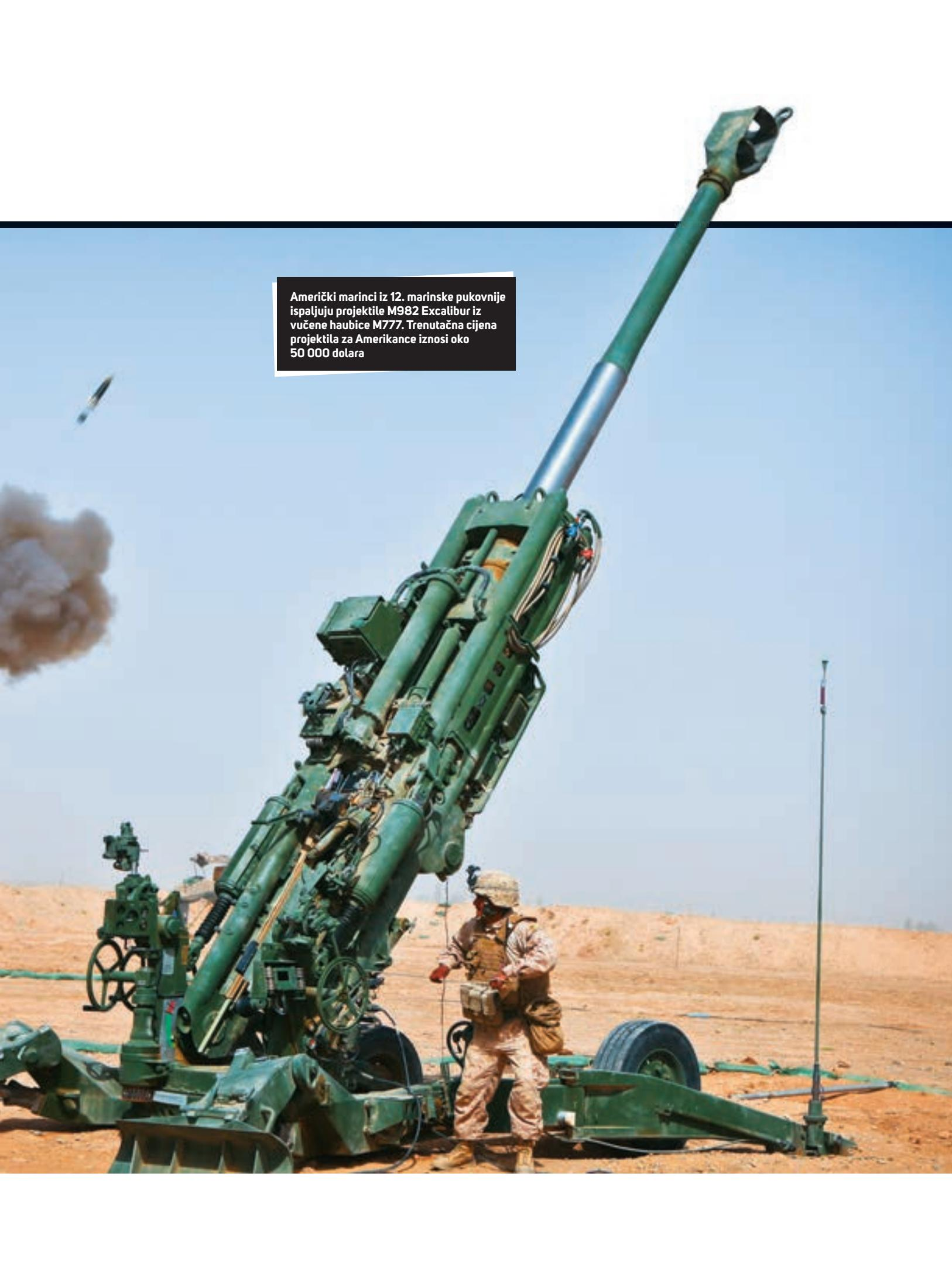
Američki marinci iz 12. marinske pukovnije ispaljuju projektille M982 Excalibur iz vučene haubice M777. Trenutačna cijena projektila za Amerikance iznosi oko 50 000 dolara
