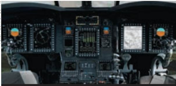
**Upravljačka ploča sustava CAAS (Common Avionics Architecture System) kod helikoptera Chinook. Taj sustav ugrađen je i u helikopter CH-53E**
