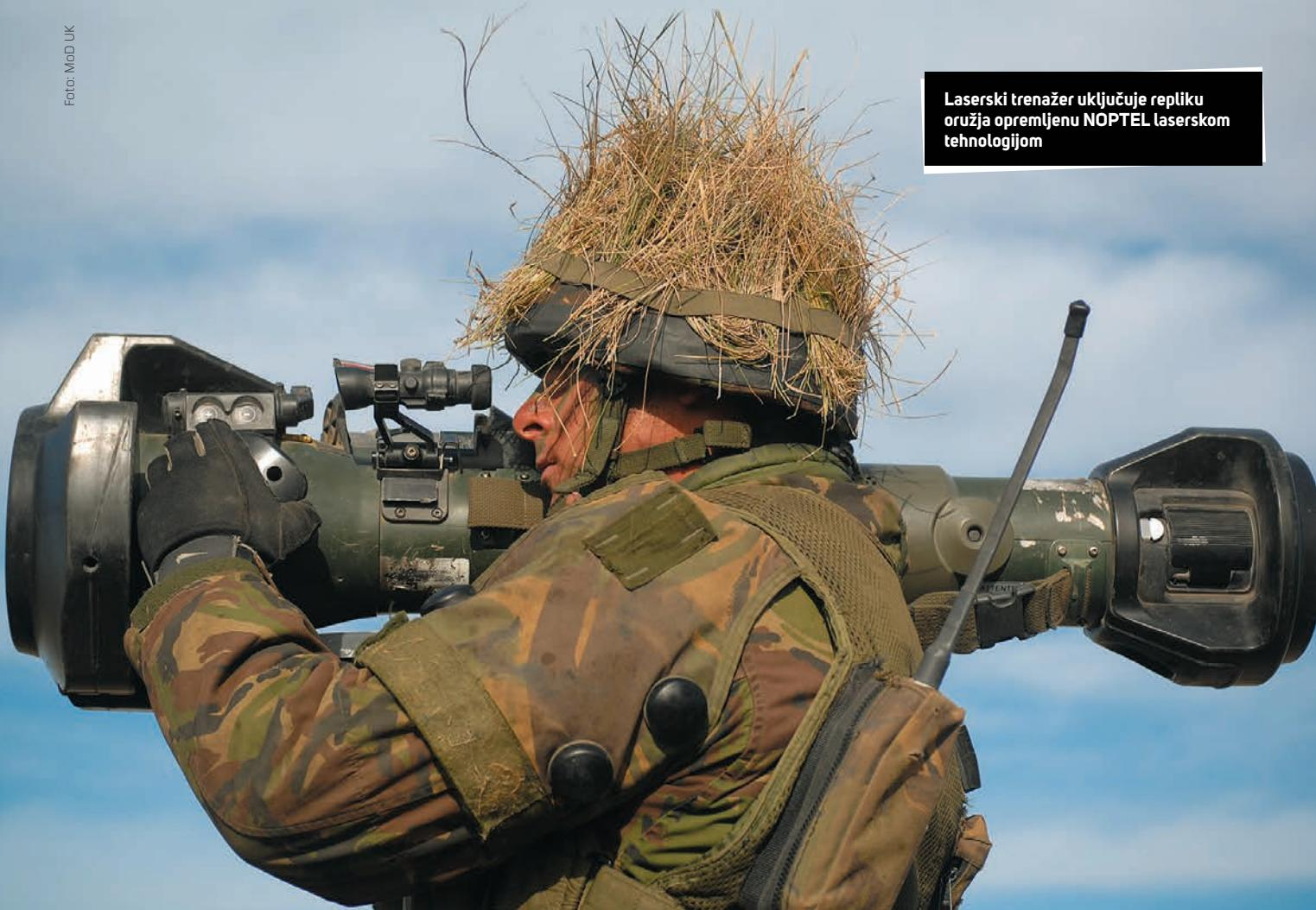
Laserski trenažer uključuje repliku oružja opremljenu NOPTEL laserskom tehnologijom
