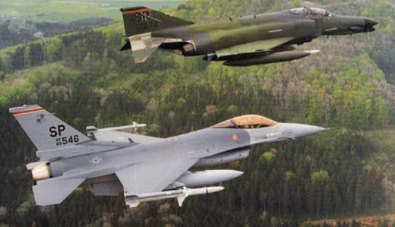
**Avioni F-4G i F-16C Block 30 u letu iznad SR Njemačke 1988. godine. Dva aviona djelovala su kao tim u SEAD misijama, a učinkovito lansiranje HARM-a i s aviona F-16 omogućeno je razmjenom podataka s F-4G, koji je imao puno bolje senzore za otkrivanje i lociranje protivničkih radara**
