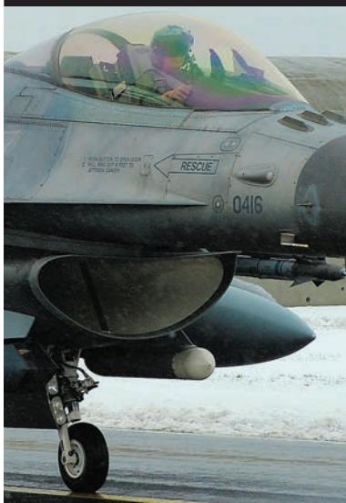
**Avion F-16 s ciljničkim sustavom HTS (HARM Targeting System) na lijevom nosaču ispod usisnika zraka. HTS pilotu i zrakoplovu pruža znatno veće mogućnosti uporabe HARM-a**
