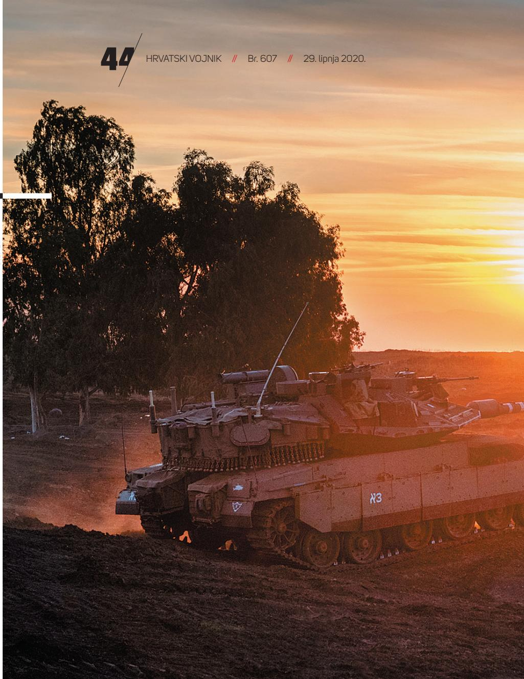
**Inačica Mark 3 pojavila se 1989. i dobila tad najsuvremeniji modularni oklop i top kalibra 120 mm**
