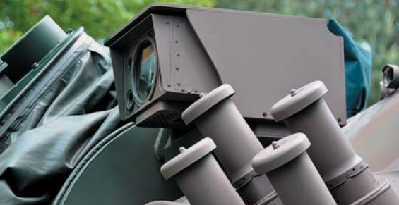
**Cijelo rješenje od 16 senzora pokriva vidno polje od 360 stupnjeva u rasponu azimuta**
