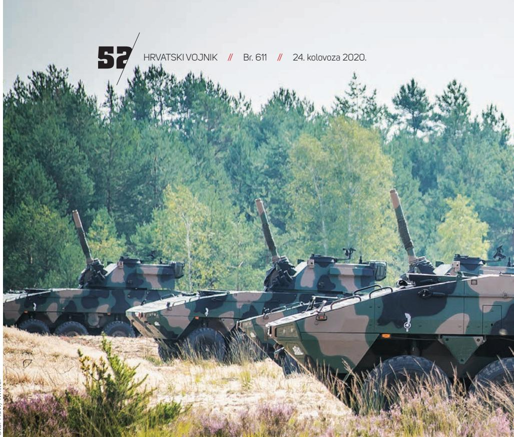
**RAK je sposoban za ispaljivanje do osam mina u minuti unutar cijelog raspona azimuta i elevacije**
