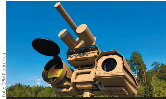
**CPM Owl višepojasni je DJI-120-4B ometač, posebno prilagođen za instalaciju na vrh kompleksnijeg sustava Guard-One**
