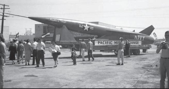
**Regulus II bio je nadzvučni krstareći projektil prosječne brzine nešto manje od dva Macha, a domet mu je iznosio oko 1850 km**
