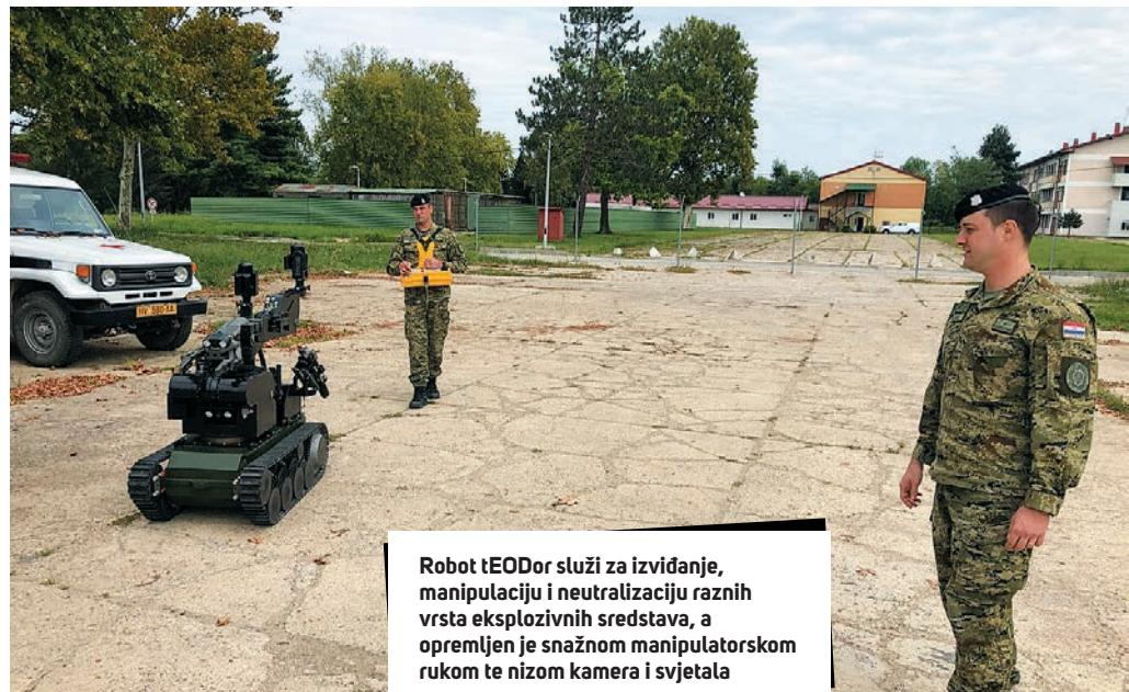
Robot tEODor služi za izviđanje, manipulaciju i neutralizaciju raznih vrsta eksplozivnih sredstava, a opremljen je snažnom manipulatorskom rukom te nizom kamera i svjetala
