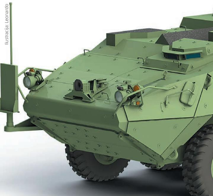
**Borbeno vozilo Stryker 8 x 8 konfigurirano za IM-SHORAD moći će ispaljivati rasprskavajuće streljivo 30 x 113 mm koje će se programirati za eksplodiranje u neposrednoj blizini letjelice**
