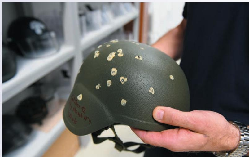
**Jedna od kaciga testiranih u tvtkinom laboratoriju za ispitivanje protubalističkih sredstava**
