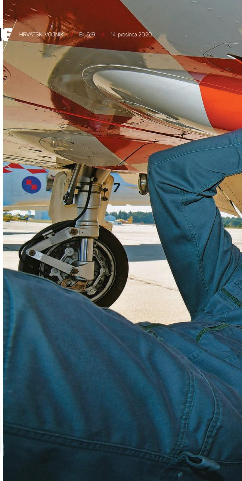
pregled odvija se tako da se prati *check lista* te se zrakoplov, avion ili helikopter, detaljno pregledava. Ako se uoči veći otklon od propisanog standarda, tad se zrakoplov upućuje na drugi stupanj održavanja. Za nas je najvažnije uvjeriti se da je avion potpuno ispravan za letačke zadaće u idućem tjednu. Naravno, prije svakog leta provjerava se je li sve u redu, no ponедjeljak je dan kad se radi pokretanje motora zrakoplova, pranje kompresora i slično," objaš-
