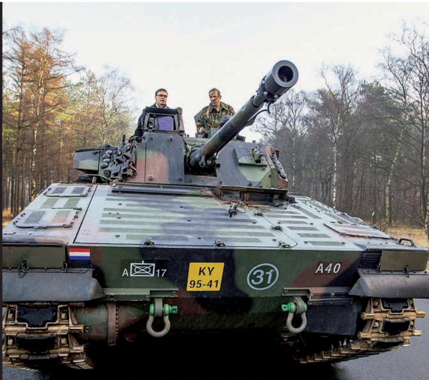
**Jedno od nizozemskih vozila CV9035NL koja su 2016. isporučena Estoniji. Kupola je opremljena automatskim topom Bushmaster III od 35 mm**
